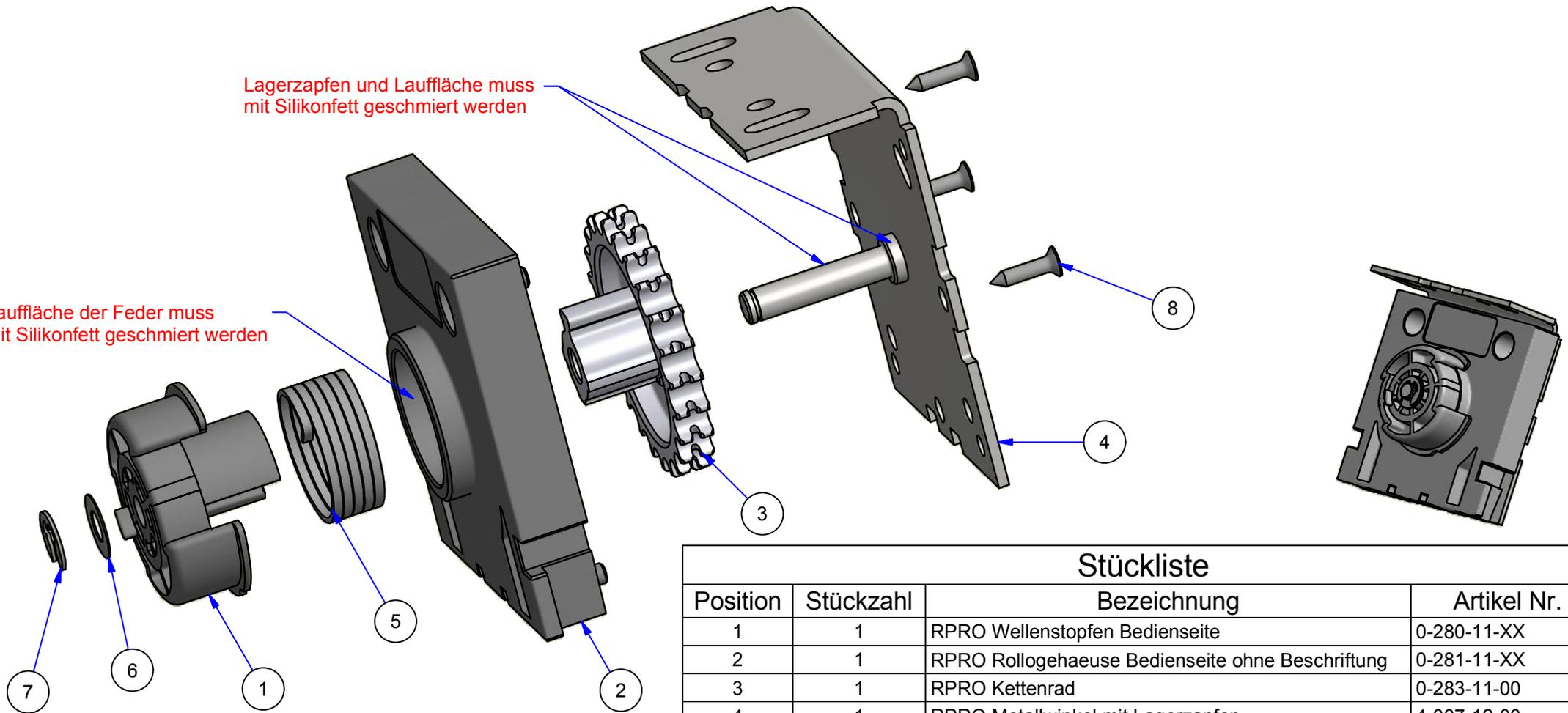
bei Montage der Schleppfeder und des Kettenrads, muss auf die Position der Mitnehmernase geachtet werden
